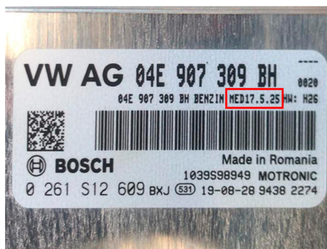
Маркировка блоков ЭБУ
