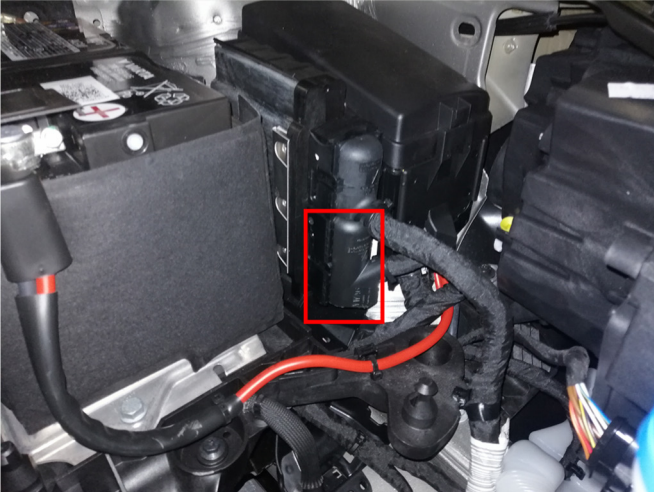
Место подключения стартера
