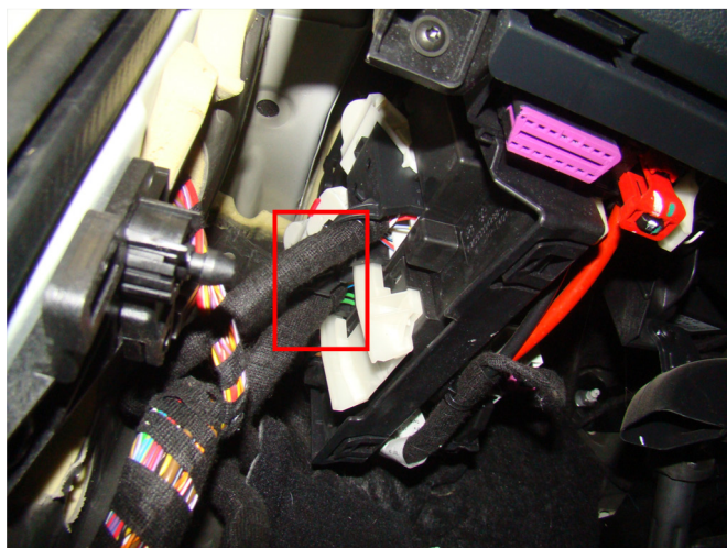
Место подключения цепей зажигания
