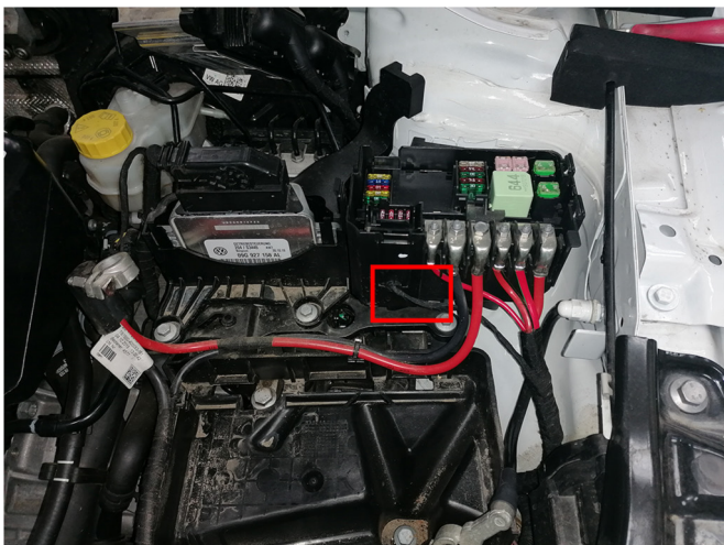
Вариант 1. Место подключения к стартеру
