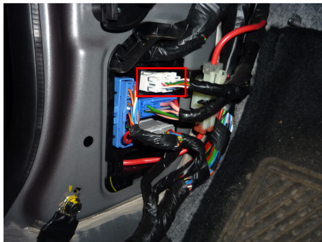
Место подключения (синий провод, контакт №19)
