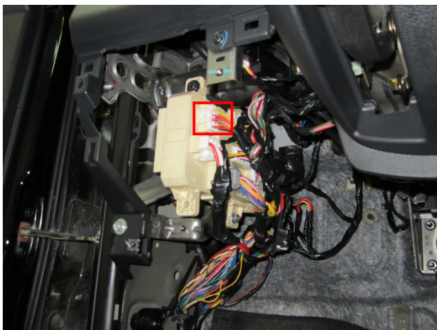
Рис.5 Место подключения к силовым цепям запуска двигателя
